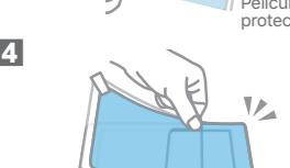
Coloque el extremo de la película en la pantalla de cristal líquido y alínearlo.
